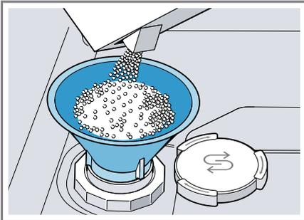
Het reservoir voor onthardingszout volledig met onthardingszout vullen. Het water in het reservoir wordt verdrongen en stroomt weg.
