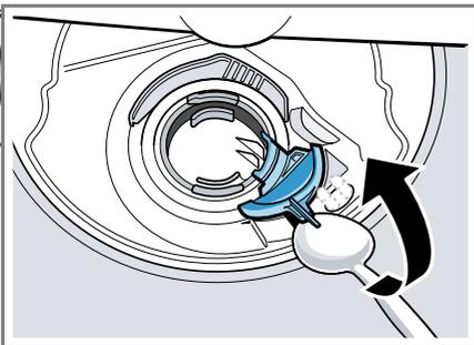
6. De pompafdekking schuin naar binnen optillen en verwijderen.
