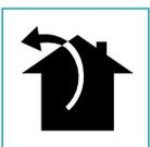
Bei dieser Ausführung werden die Dämpfe über ein Abzugsrohr nach außen abgeleitet. Deshalb muss der Anschluss der Haube für den Abzug mit einem Rohr an einem externen Abzug angeschlossen werden.
