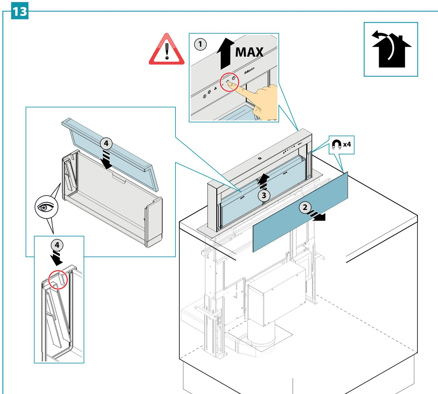
IT - Installazione filtro carbone-zeolite (opzionale) (14).
